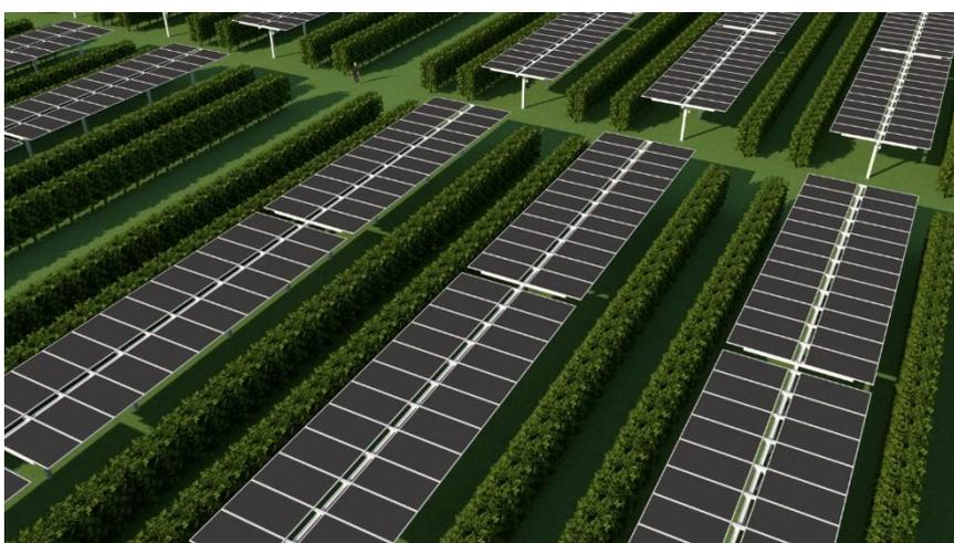
*Figura 41 - Schizzo dell'assetto impiantistico: un filare FV e due siepi ulivicole alternate*
