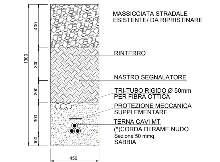
SEZIONE B-B CAVIDOTTO MT INTERRATO 1 TERNA DI CAVI PERCORSO SU STRADA ESISTENTE IN MASSICIATA O TERRENO
