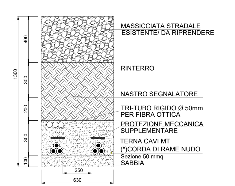
SEZIONE C-C CAVIDOTTO MT INTERRATO 2 TERNE DI CAVI PERCORSO SU STRADA ESISTENTE IN MASSICIATA
