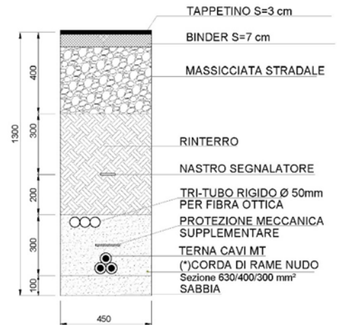
SEZIONE B-B CAVIDOTTO MT INTERRATO 1 TERNA DI CAVI PERCORSO SU STRADA ESISTENTE ASFALTATA
