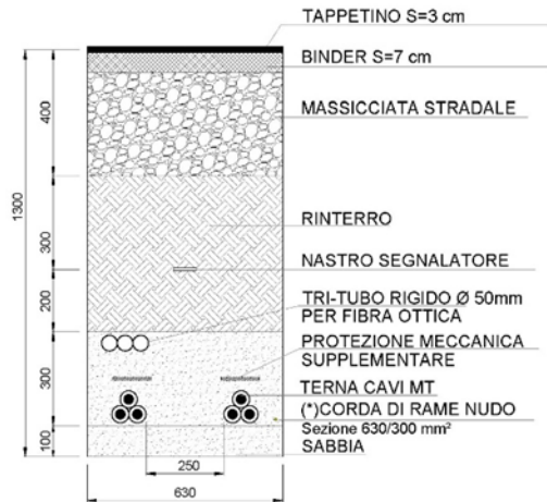
SEZIONE A-A CAVIDOTTO MT INTERRATO 2 TERNE DI CAVI PERCORSO SU STRADA ESISTENTE ASFALTATA
