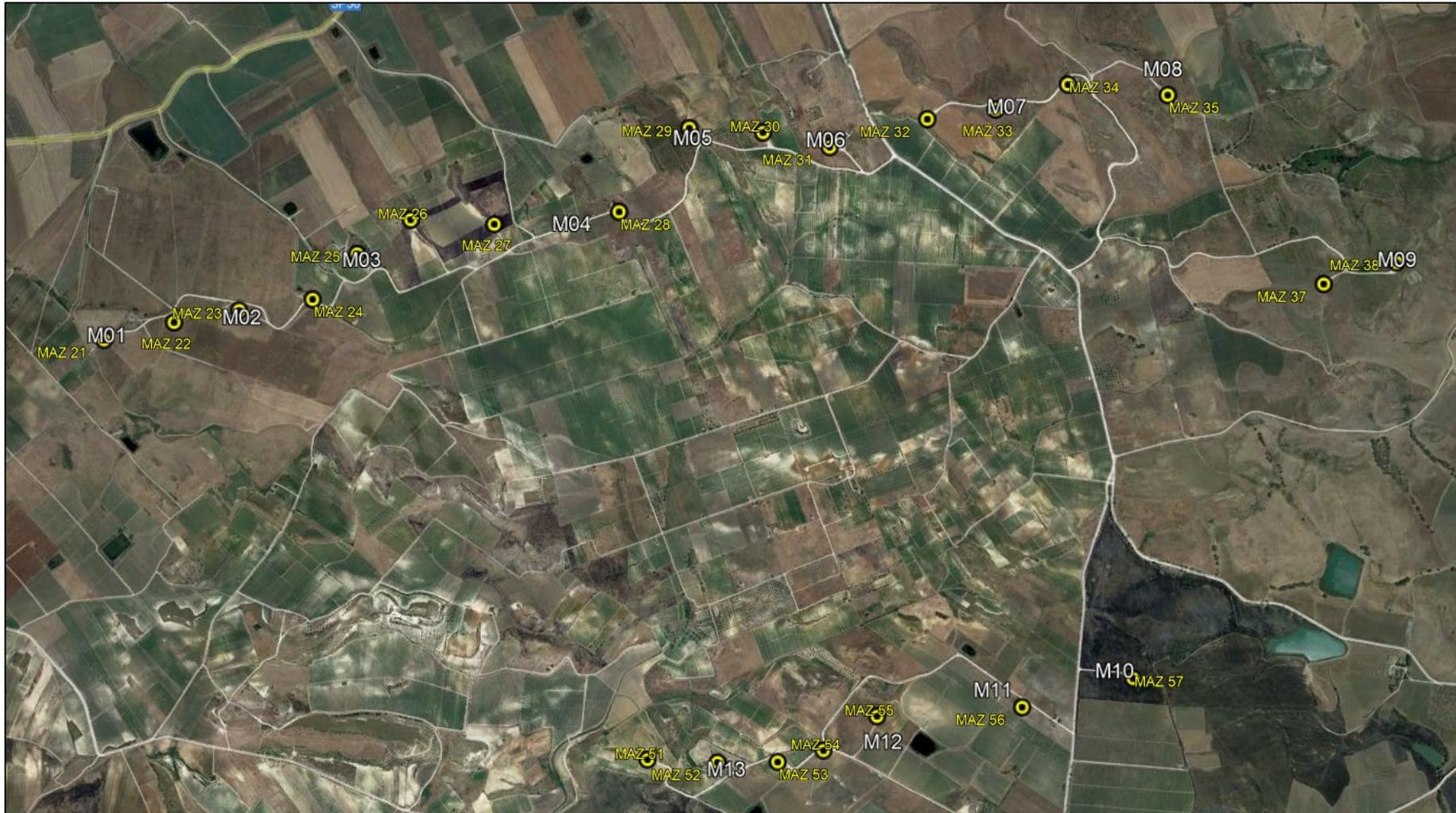
**Figura 2: Individuazione dell'area di installazione della Windfarm su immagine ortofotografica con evidenza dell'impianto di progetto (etichette bianche) e delle posizioni degli impianti esistenti oggetto di repowering (etichette gialle).**
