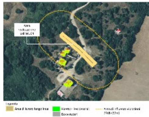
Figura 20 Realizzazione pali MU04 – Area di influenza delle vibrazioni relativa al limite dei 77 dB(A) diurni per i ricettori residenziali (in arancione) ed i ricettori potenzialmente interessati da effetti di disturbo
