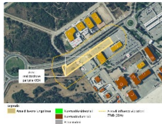
Figura 22 Realizzazione pali pile VI04 – Area di influenza delle vibrazioni relativa al limite dei 77 dB(A) diurni per i ricettori residenziali (in arancione) ed i ricettori potenzialmente interessati da effetti di disturbo
