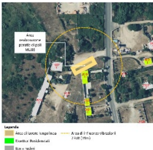
Figura 21 Realizzazione pali MU05 – Area di influenza delle vibrazioni relativa al limite dei 77 dB(A) diurni per i ricettori residenziali (in arancione) ed i ricettori potenzialmente interessati da effetti di disturbo
