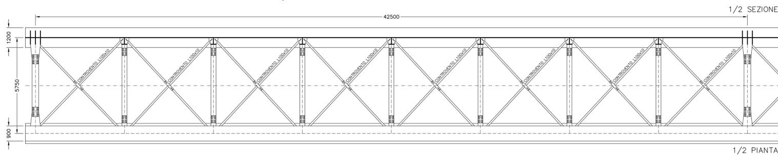
SEZIONE LONGITUDINALE CAMPATE 1-13 CARREGGIATA DX-SX tipo L=42,5m SCALA 1:100
