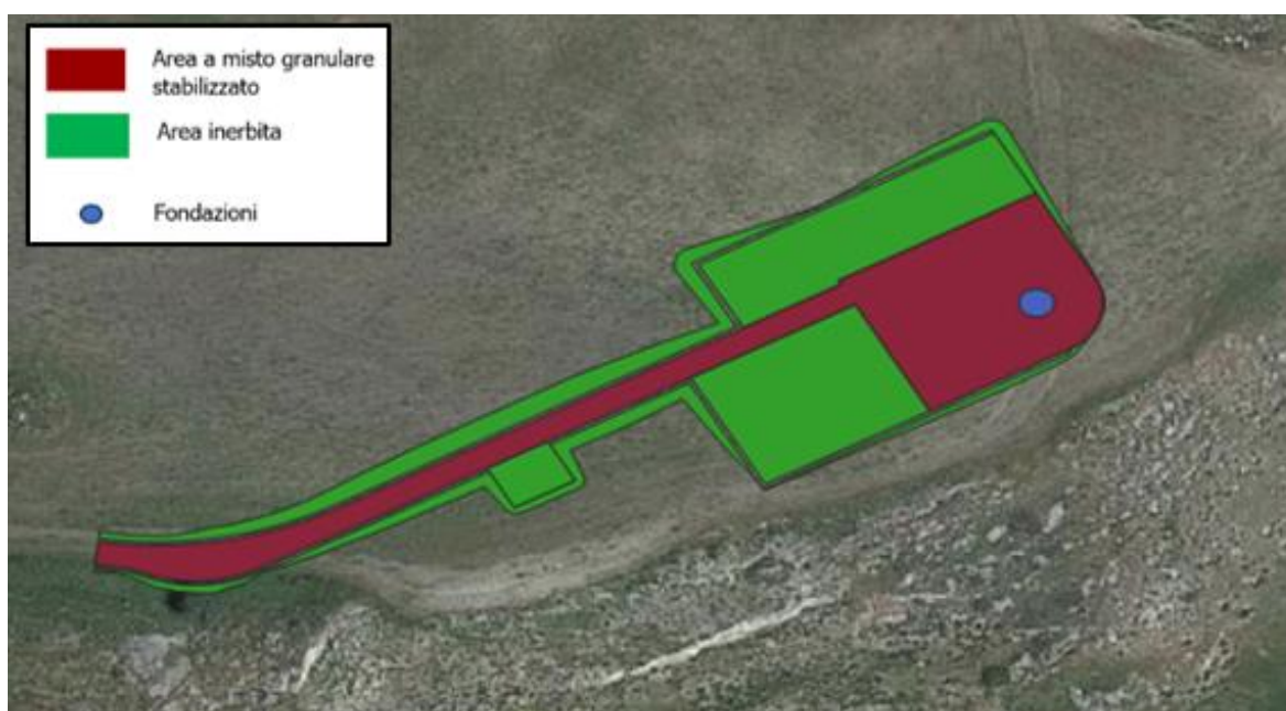
Figura 2-59 Rappresentazione su immagine satellitare della piazzola AD01, con fondazione aerogeneratore e relativa via di accesso
