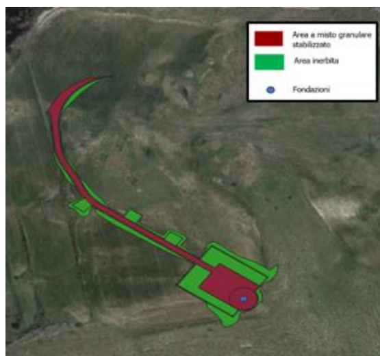
Figura 2-60 Rappresentazione su immagine satellitare della piazzola AD02, con fondazione aerogeneratore e relativa via di accesso
