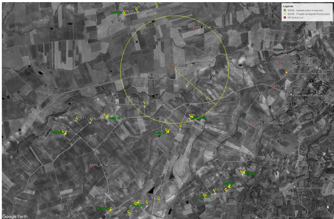
Figura 3: interferenza WTG_05_NP_SICILIA 2. Il cerchio rappresentato ha raggio pari alla distanza minima di 1.190m parallelamente alla direzione del vento come da DM 10.09.2010
