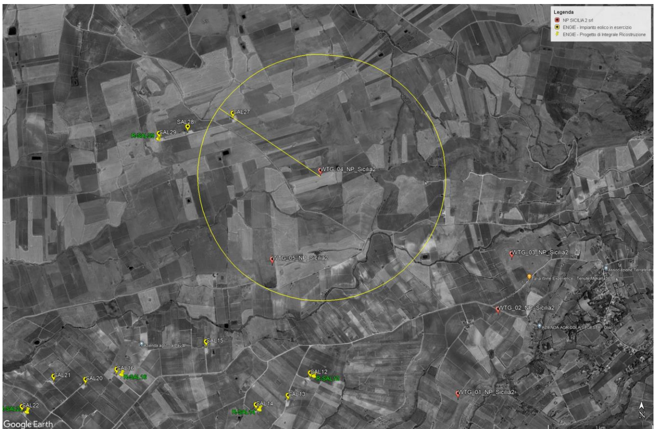
Figura 1: interferenza WTG_04_NP_SICILIA 2. Il cerchio rappresentato ha raggio pari alla distanza minima di 1.190m parallelamente alla direzione del vento come da DM 10.09.2010.
