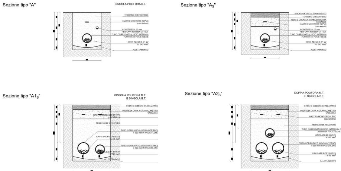
Figura 1– Sezioni tipo cavidotti interni BT ed MT
