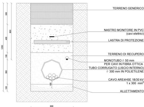
**Figura 3 – Sezione tipo X-X' del cavidotto esterno MT verso SE**
