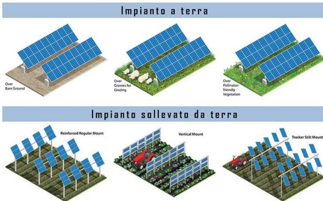
Figura 21 - Tipologie di impianti agrovoltaici, fonte NREL
