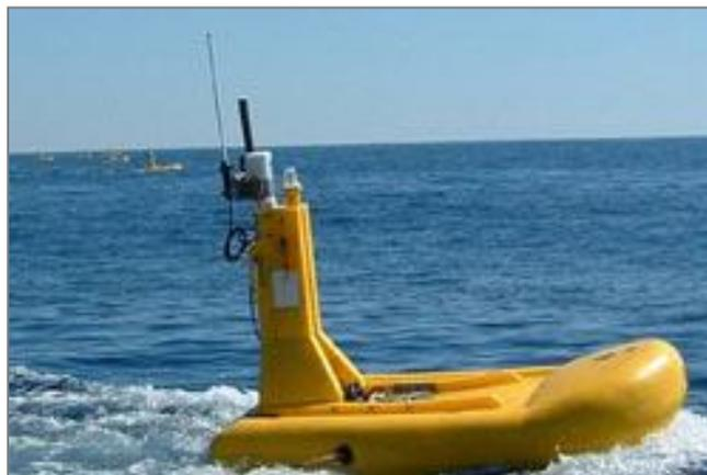
**Figura 3.24 - Esempio di boa di coda in cui è visibile una parte del cavo sismico (fonte: [www.jamstec.go.jp](http://www.jamstec.go.jp))**
