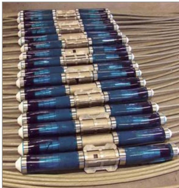
Figura 3.22 - Esempio di una serie di idrofoni usati nella prospezione sismica in mare (fonte: [www.oilonline.com](http://www.oilonline.com))
