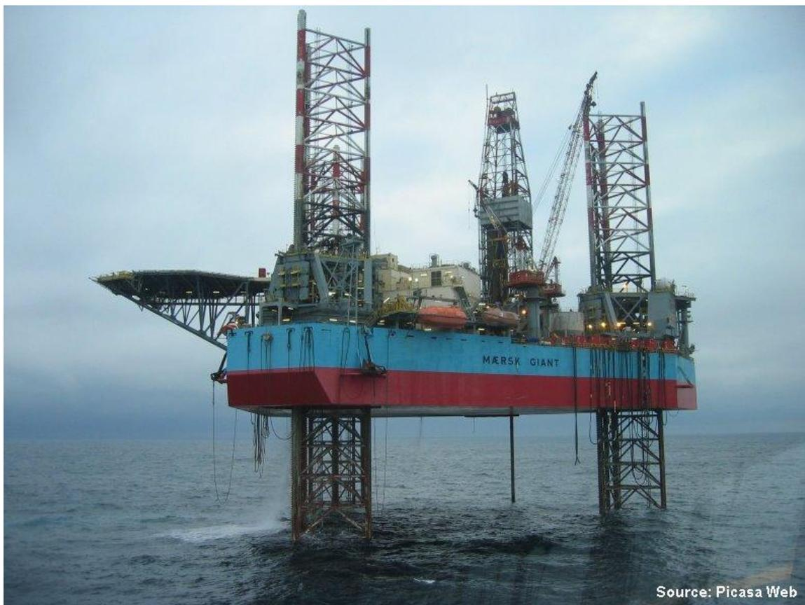
Figura 3.25 – Esempio di piattaforma mobile o jack-up (fonte: [www.isleofbarra.com](http://www.isleofbarra.com))
