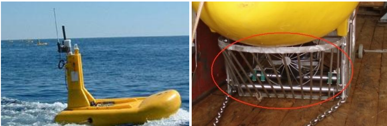
Figura 6.1 – A sinistra: esempio di Boa di coda, fissata all'estremità del cavo sismico (fonte: www.mitchamindustries.com ). A destra: dispositivo che esclude la possibilità di intrappolamento delle tartarughe marine, (fonte: www.ketosecology.co.uk )
