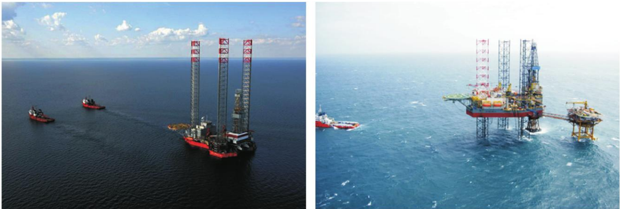
Figura 3.46 – Piattaforma di perforazione autosollevante in navigazione trainata da rimorchiatori, a sinistra (fonte: www.en.murmanshelf.ru ) e in fase di perforazione, a destra (fonte: www.pvdrilling.com.vn )
