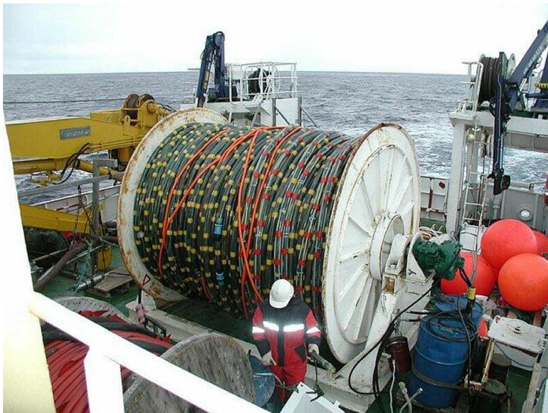
Figura 3.44 – Streamer o cavo sismico per l'acquisizione (fonte: www.geo.uib.no )
