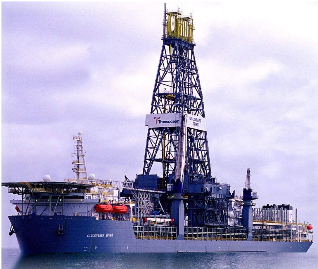
Figura 3.49 – Esempio di nave di perforazione o drilling ship (fonte: www.drillingahead.com )
