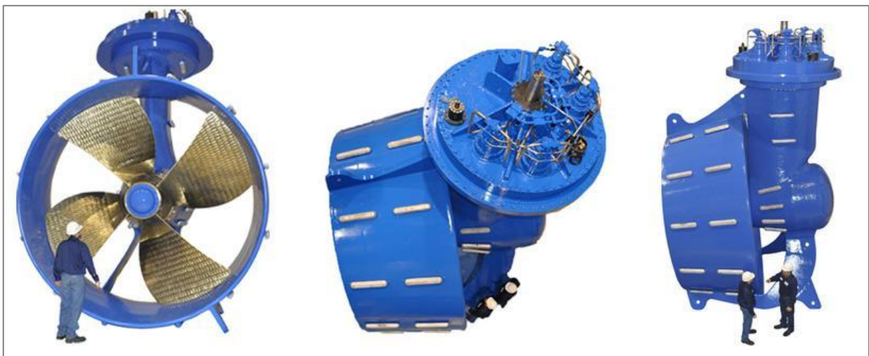
Figura 3.50 – Thrusters, generatori di spinta, che servono a contrastare le correnti marine e i venti in superficie, i quali porterebbero il mezzo alla deriva. Il thrusters è il mezzo per il posizionamento satellitare dinamico, associato al GPS, più utilizzato ed è in grado di mantenere perfettamente la verticale sulla testa del pozzo (fonte: www.sname.org )
