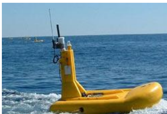
Figura 3.45 – Boa di coda alla quale viene fissata l'altra estremità dello streamer (fonte: www.mitchamindustries.com )
