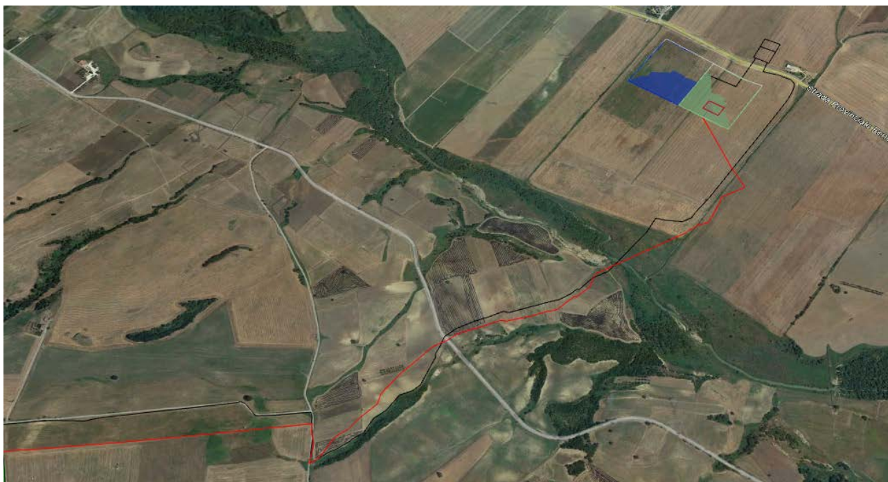
Tracciato del cavidotto
