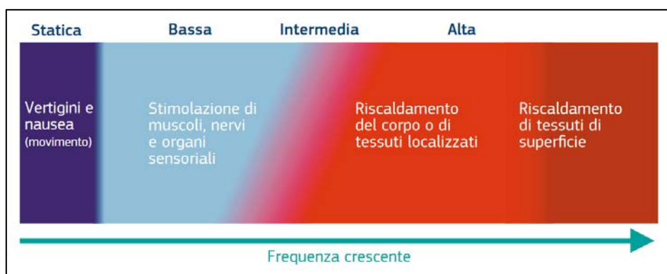
Figura 10: Effetti dei campi elettromagnetici con diverse gamme di frequenza (gli intervalli di frequenza non sono in scala)
