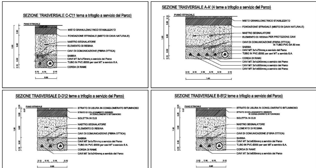
Figura 6: Differenti tipologie di posa del cavidotto
