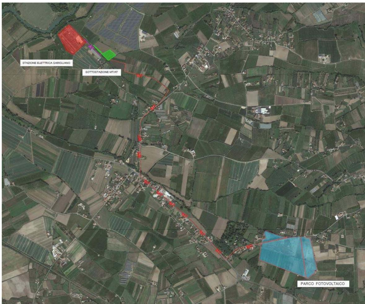
*Ortofoto con indicazione del Parco Fotovoltaico e del cavo di connessione alla Sottostazione Elettrica d’Utenza (SSE) di proprietà del Produttore.*
