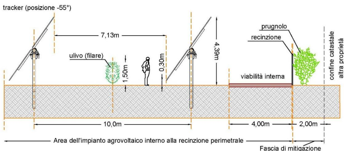
SEZIONE TIPO DELLA FASCIA A (2,00 metri) - OPERE DI MITIGAZIONE VISIVA E DI INSERIMENTO AMBIENTALE
