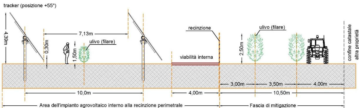
SEZIONE TIPO DELL'AREA B (10,50 metri) - OPERE DI MITIGAZIONE VISIVA E DI INSERIMENTO AMBIENTALE
