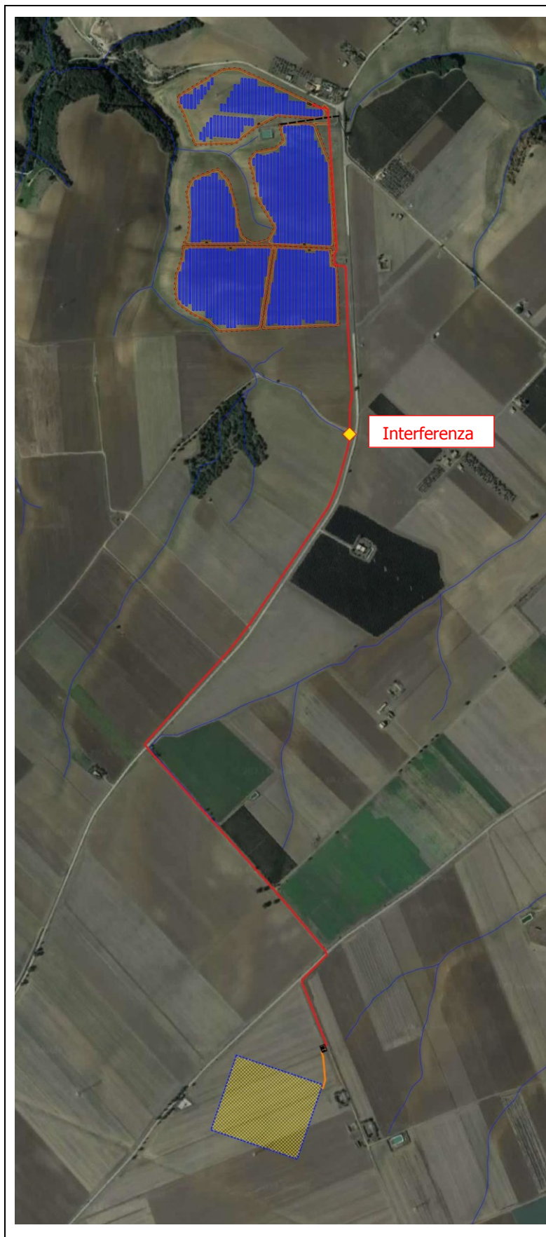
Figura 8. Interferenza tra cavidotto e reticolo idrografico.
