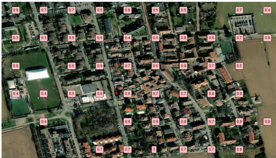
Fig. 19 Visualizzazione del punto di riferimento dell'analisi Local (triangolo rosso) ed indicazione dei punti Regional più vicini con i rispettivi valori di velocità calibrati.
