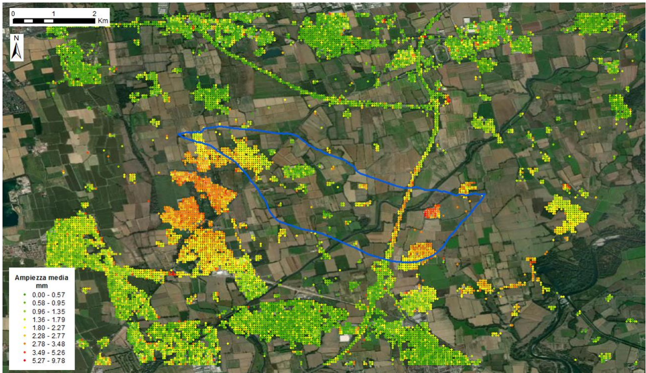
Fig. 30 Dataset Sentinel. Valori medi di ampiezza della stagionalità calcolati per la componente orizzontale dei PS Local; in blu la proiezione in superficie del giacimento.
