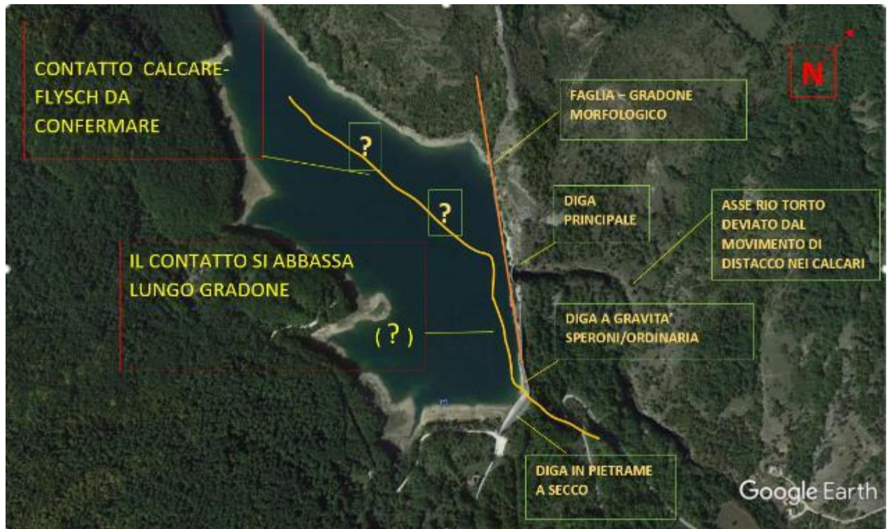
Figura 4-8 - Lago di Montagna Spaccata. Vista aerea con dettaglio sui tratti significativi della geologia in prossimità delle opere
