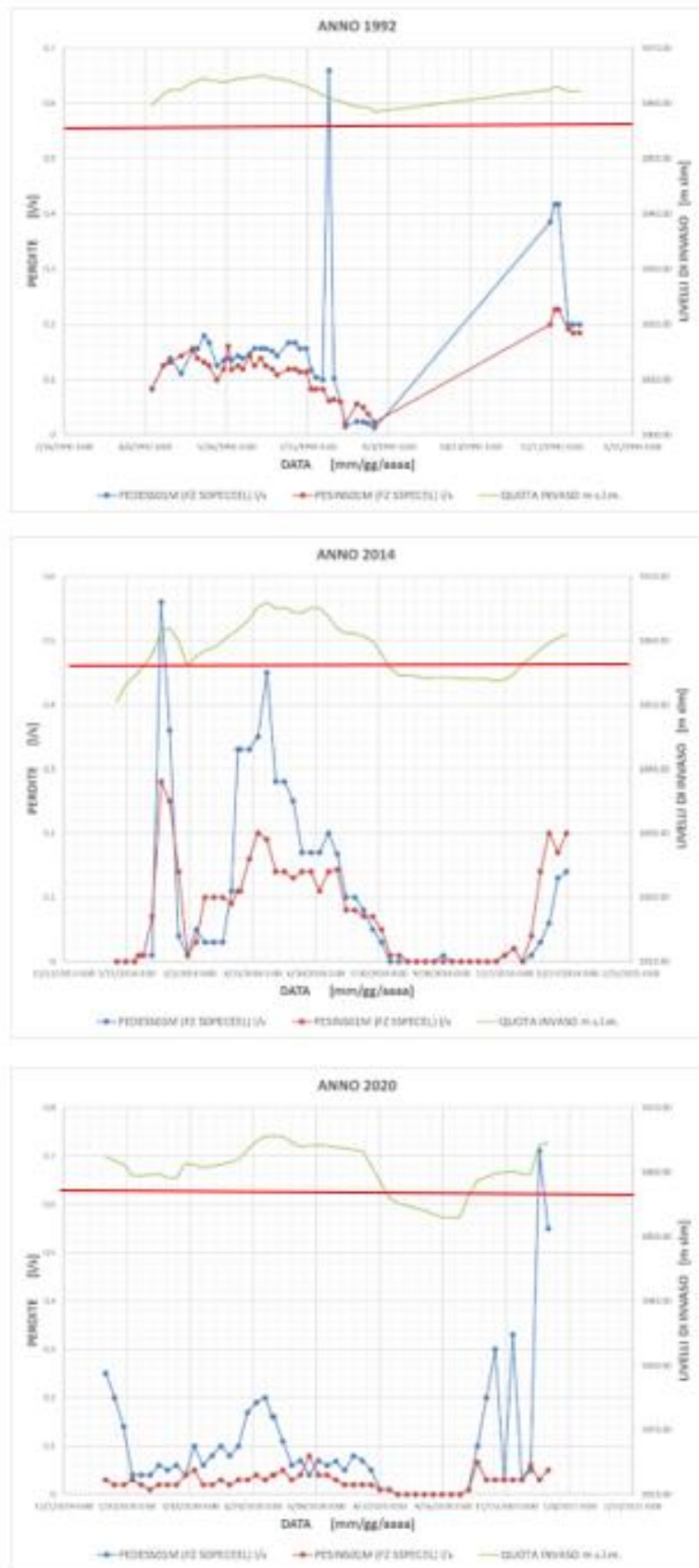
Figura 3-39 - Invaso di Montagna Spaccata. Diga 3 in pietrame a secco. Monitoraggio delle perdite. Dettaglio di 3 cicli tipici (anno 1992, 2014, 2020)
