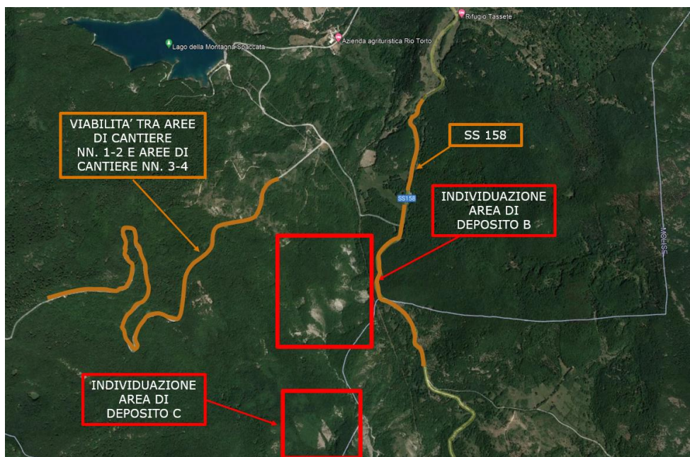
Figura 5-28: Individuazione aree di deposito permanente B-C
