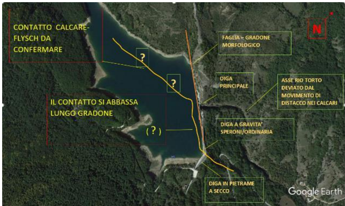
Figura 6-47 - Lago di Montagna Spaccata. Vista aerea con dettaglio sui tratti significativi della geologia in prossimità delle opere
