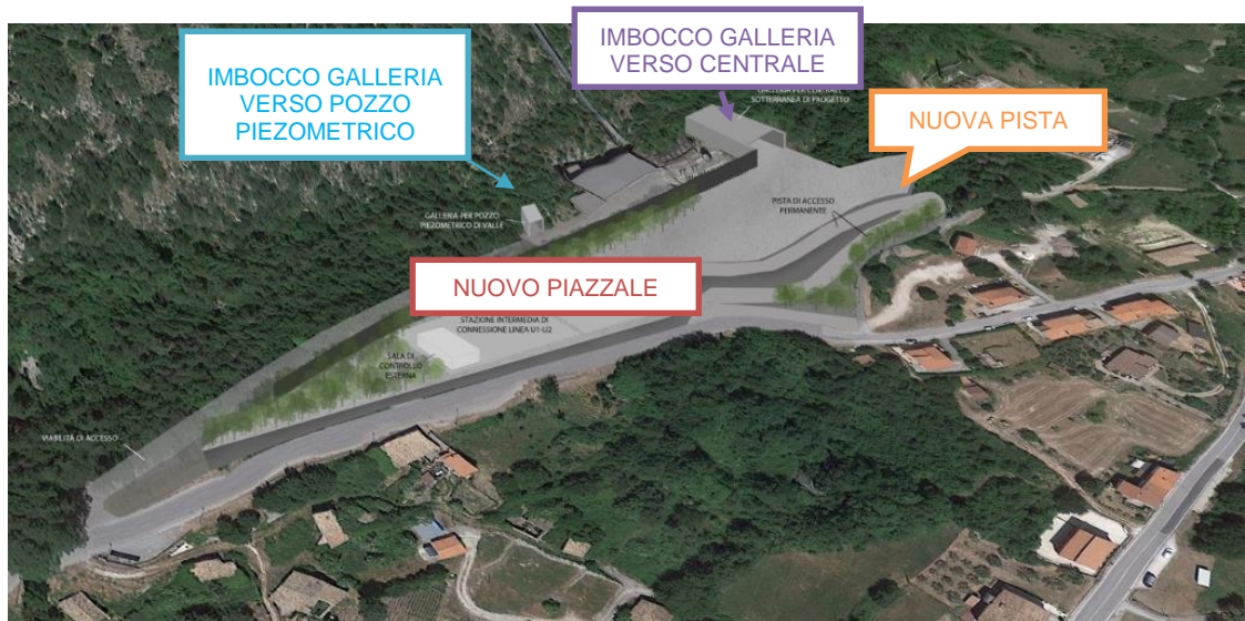
Figura 4-7. Pista di accesso nuovo piazzale della Centrale esistente Pizzone. Imbocco alle due nuove gallerie.
