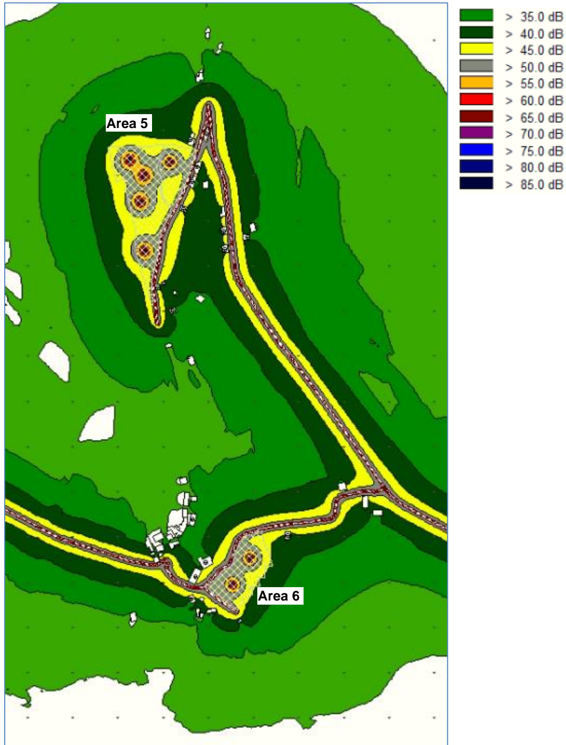
Figura 6-8. Emissione dalle aree di cantiere Area 5 e Area 6 e traffico indotto periodo NOTTURNO.
