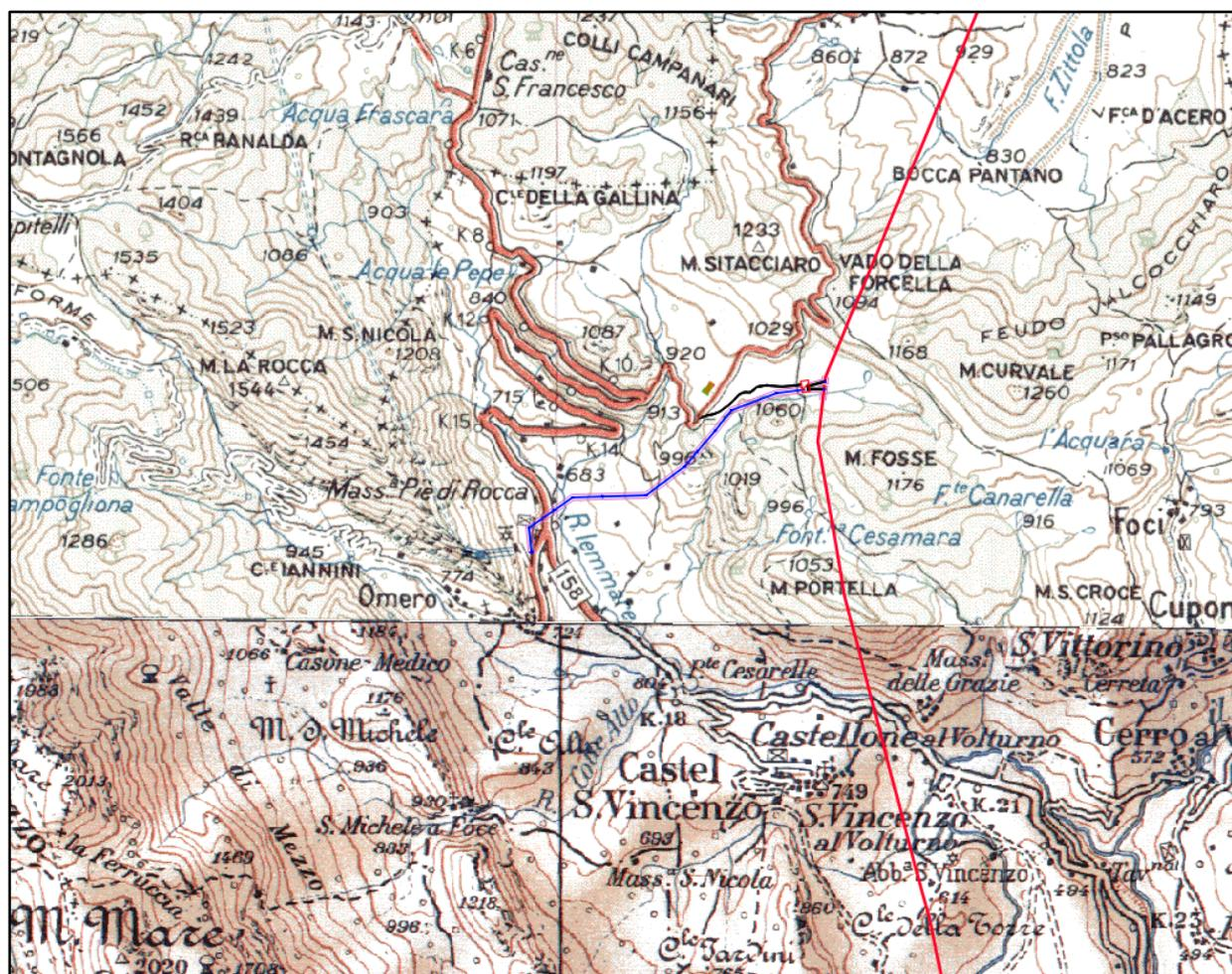
Figura 6: Inquadramento generale dell'area di studio su base carta IGM in scala 1:100.000 (livello WMS GeoPortale Nazionale). In rosso la linea AT esistente, in blu la linea di progetto.
