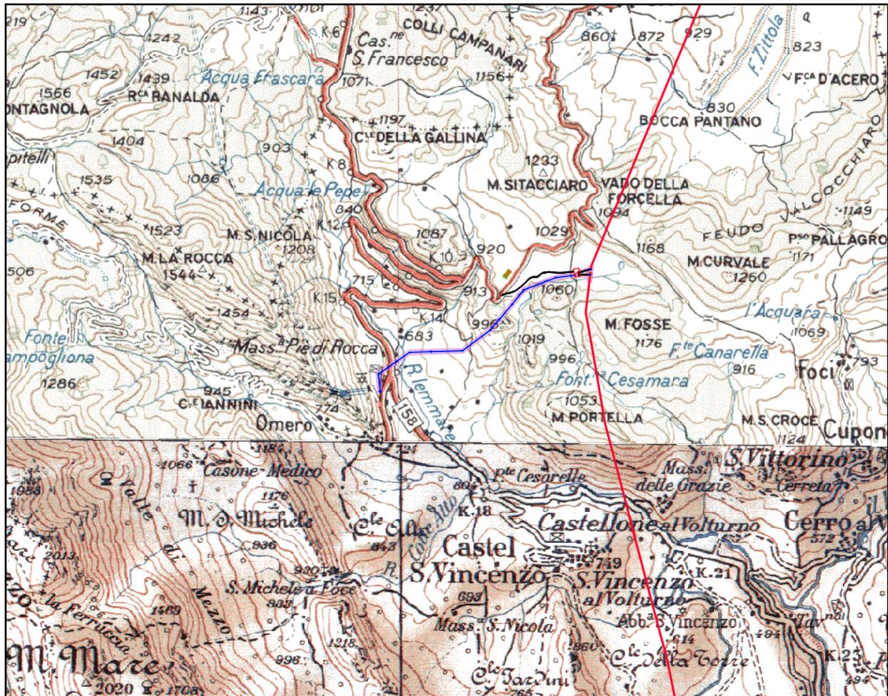
**Figura 15: Inquadramento generale dell'area di studio su base carta IGM in scala 1:100.000 (livello WMS GeoPortale Nazionale). In rosso la linea AT esistente, in blu la linea di progetto.**
