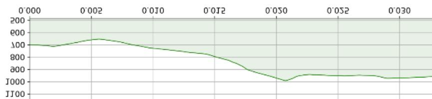
**Figura 6: Profilo altimetrico dell'elettrodotto (Fonte: realizzato con QGIS a partire dal DTM TinItaly a 10m).**
