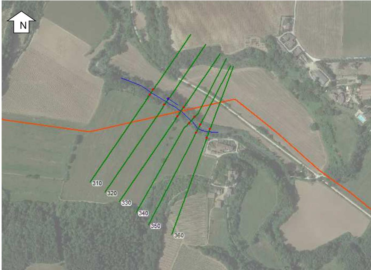
*Terzo tratto modellato in HEC-RAS (attraversamento n. 4), con relativi codici numerici delle sezioni trasversali inserite*
