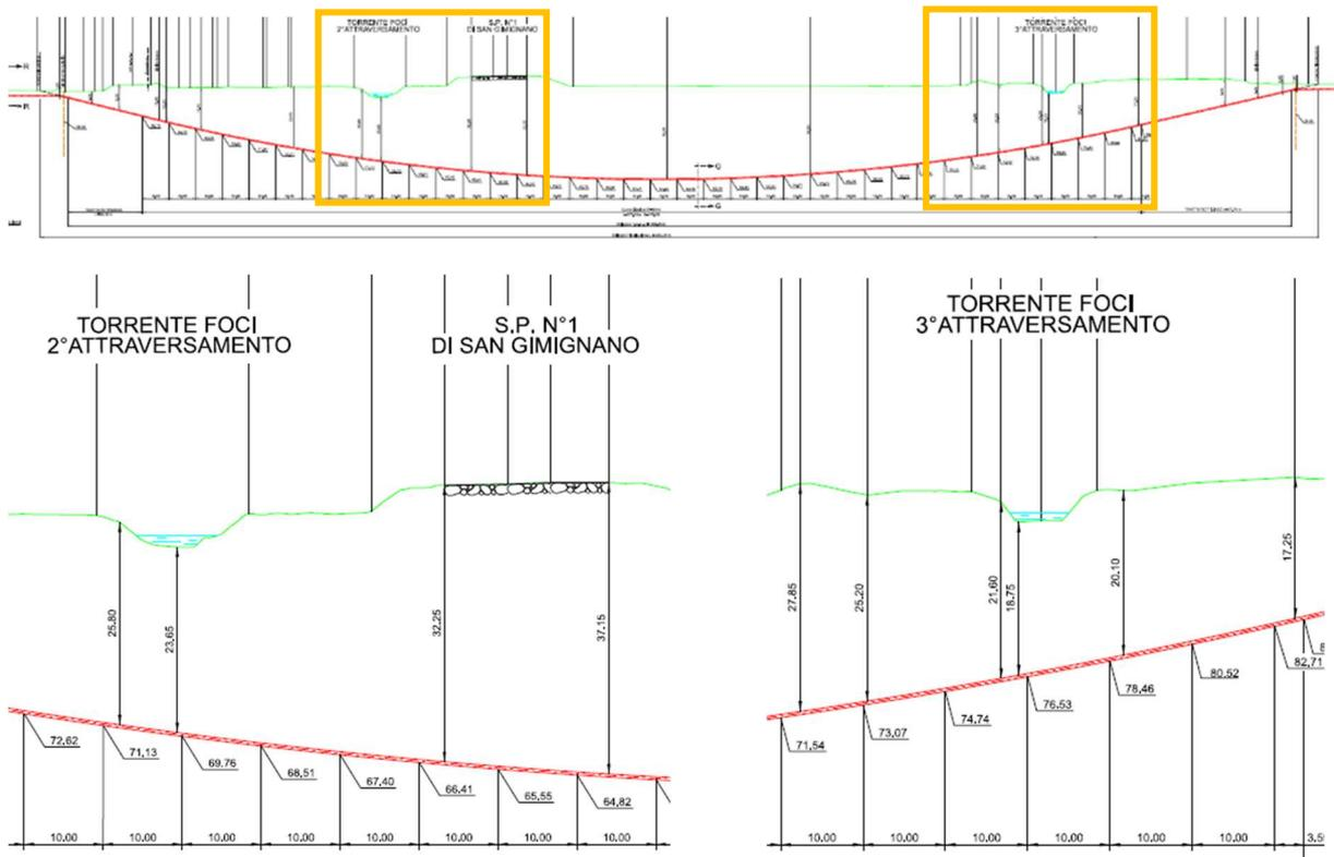
Figura 7: Attraversamenti torrente Foci (n.2 e 3) - Sezioni schematiche di progetto.
