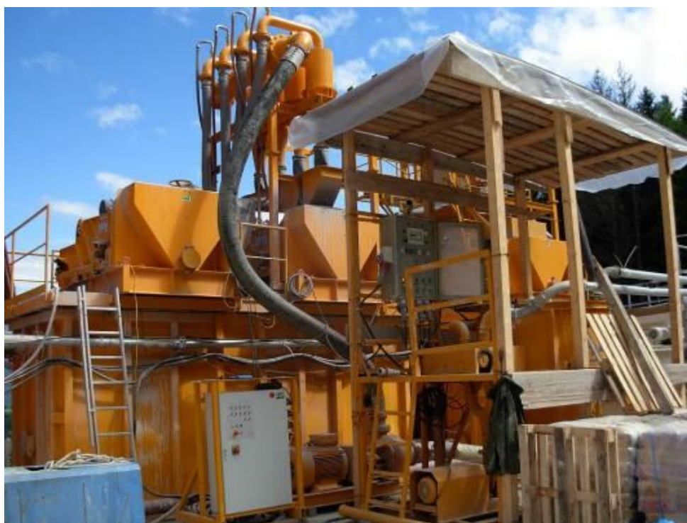
Fig. 7-23: sistema di disidratazione
