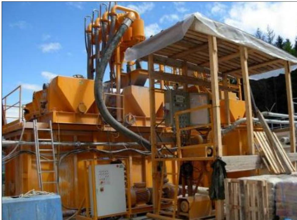
Fig. 4.21 - Sistema di disidratazione.
