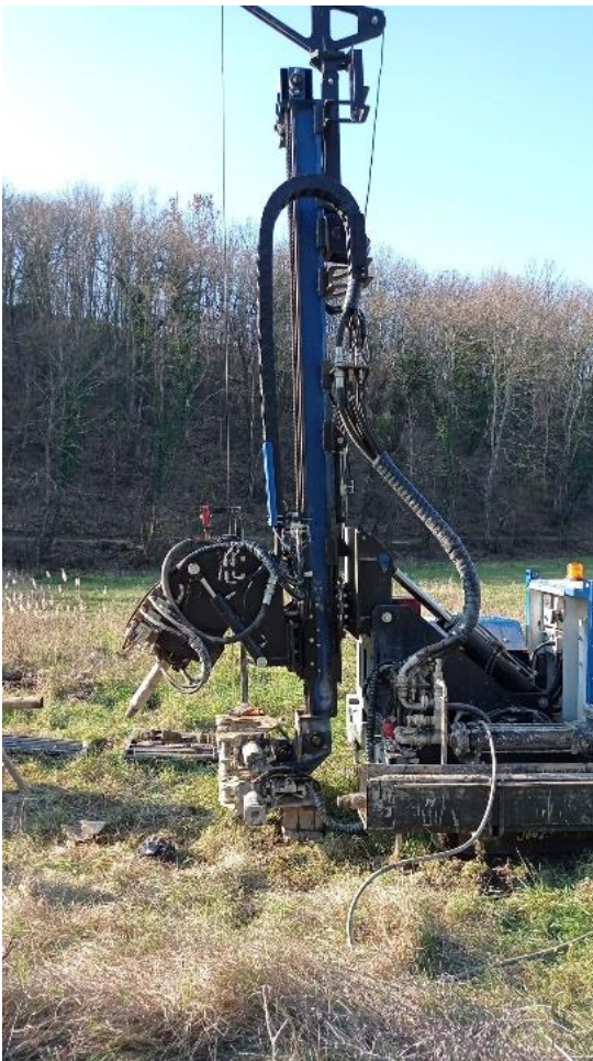
Fig. 4.2 - Posizionamento sonda (HYDRA JOY2) e cassa 0-5 m sondaggio SH7.
