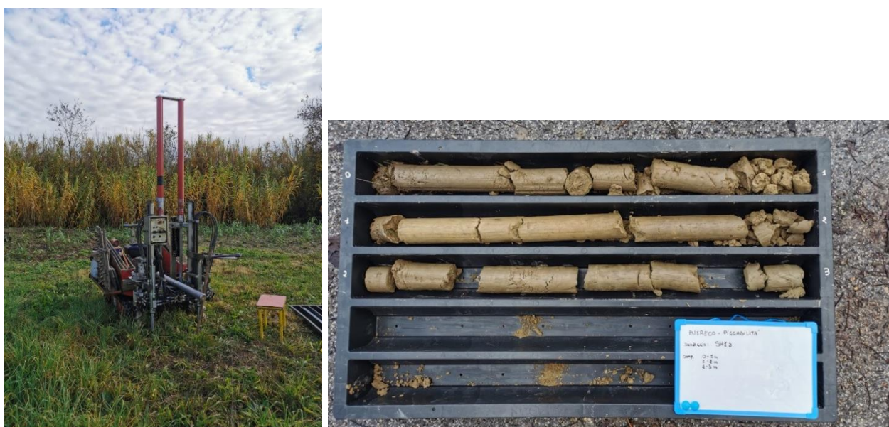
Fig. 4.1 - Posizionamento sonda (Pagani TG63-100) e cassa 0-3 m sondaggio SH1.
