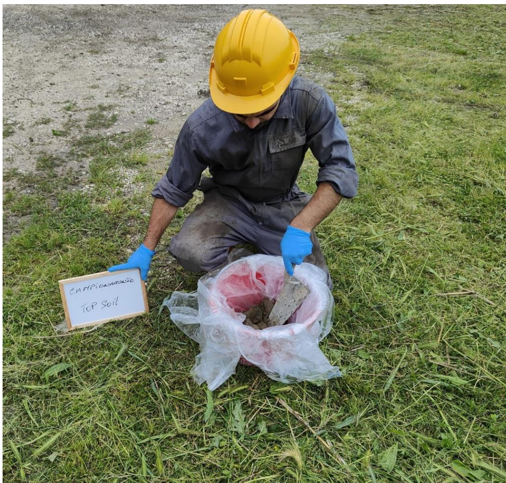
Fig. 4.4 - Esempio di campionamento Topsoil.
