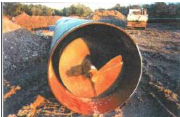
Fig. 2.3 - Coclea per trivella spingitubo.
