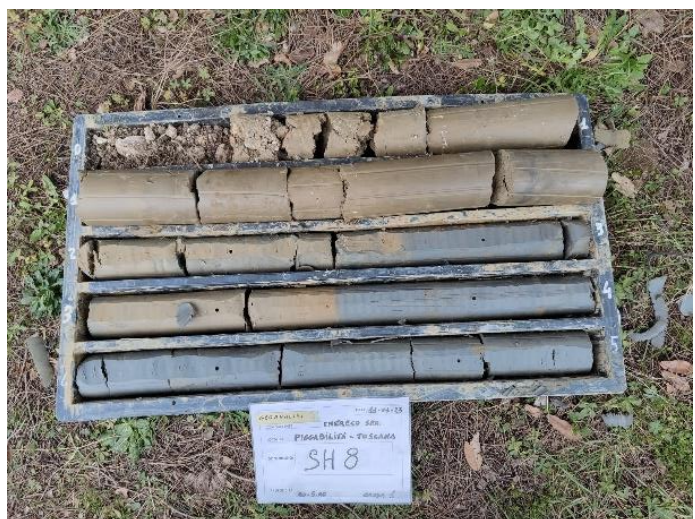
Fig. 4.3 - Posizionamento sonda (HYDRA JOY3 G) e cassa 0-5 m sondaggio SH8.
