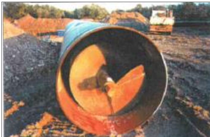
Figura 3.17 - Coclea per trivella spingitubo.
