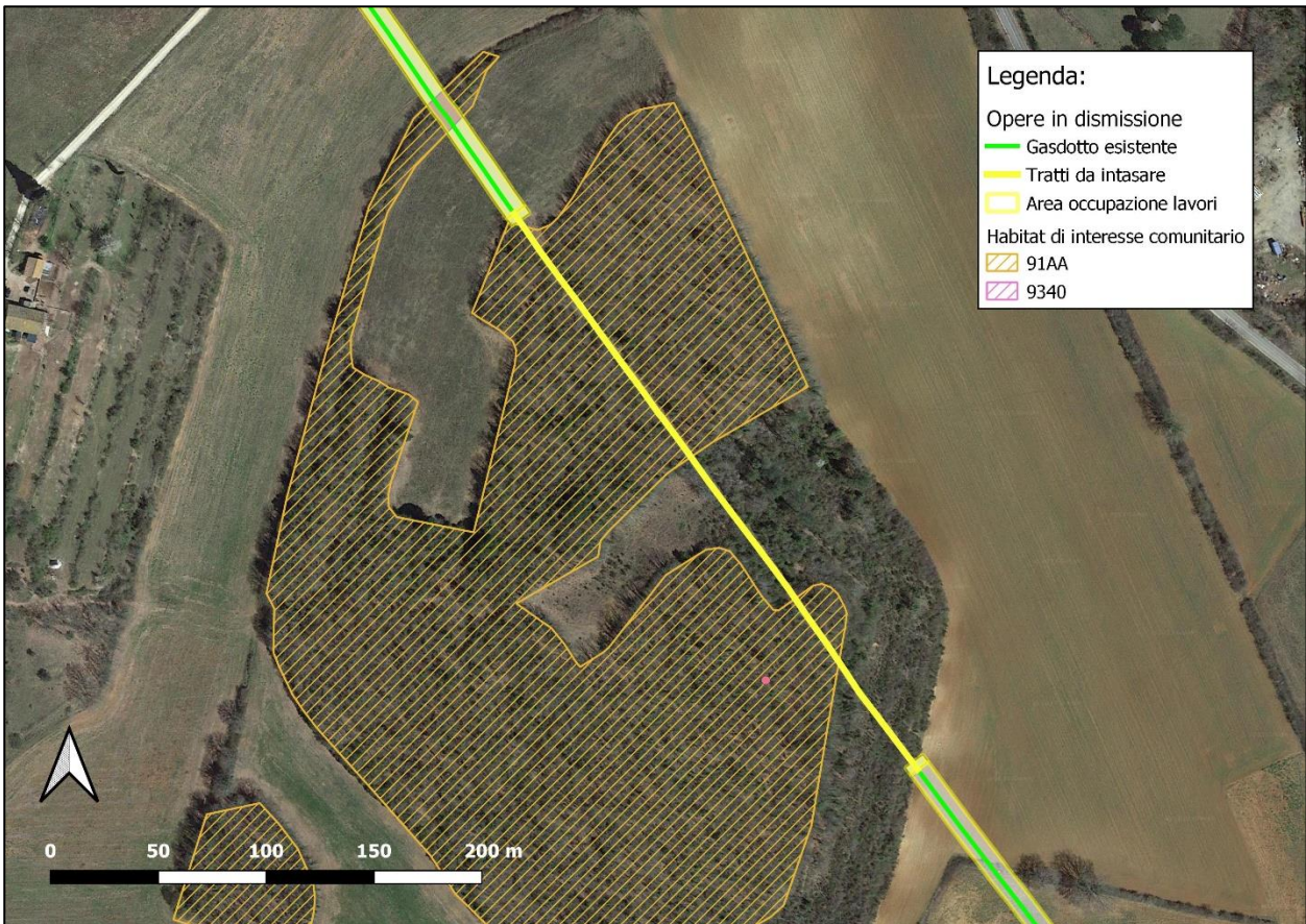
Figura 4.25: tratta del gasdotto in dismissione compresa km 26+151 al 26+163 che interessa la propaggine di habitat 91AA*, così come riportato nel progetto HaSCITu e successiva tratta di gasdotto sottesa all'habitat in cui si prevede intasamento senza apertura pista (tra il km 26+217 e il km 26+221)
