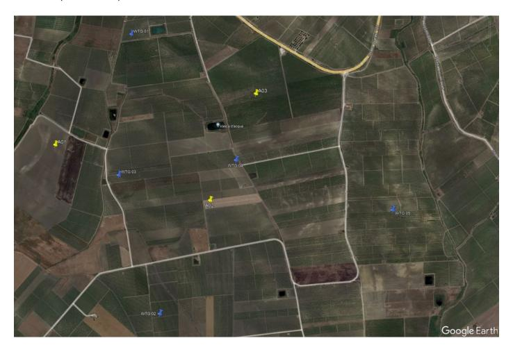
Nella figura che precede, le turbine di progetto A01, A02 e A03 sono a meno di 510 m (3 diametri) dalle turbine WTG03 e WTG04 di GRV Wind Sicilia 8 S.r.l.
