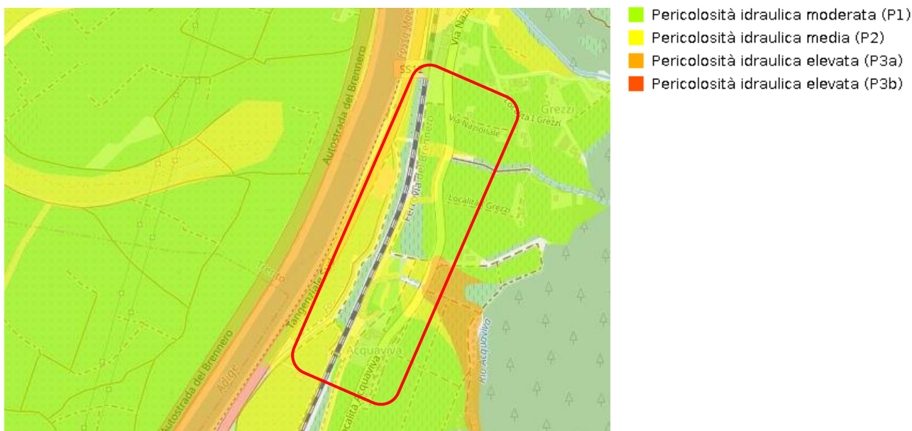
Figura 2: Mappatura delle aree a pericolosità del PGRA da SIGMA Distretto Alpi Orientali
