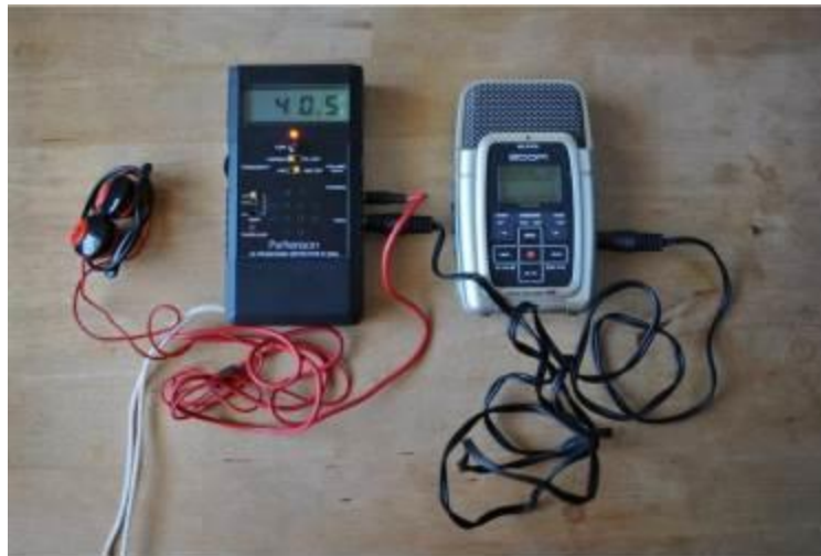
Figura 5-2: Strumentazione per i rilievi ultrasonori manuali: a sinistra bat detector D240 X Pettersson Elektronik, a destra Registratore Digitale Zoom H2.
