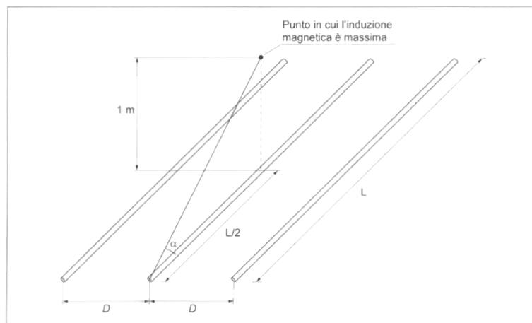
Ad *un metro* di distanza dalle sbarre (quindi ancora all'interno della torre) l'induzione magnetica assume il suo massimo valore<sup>1</sup>:
