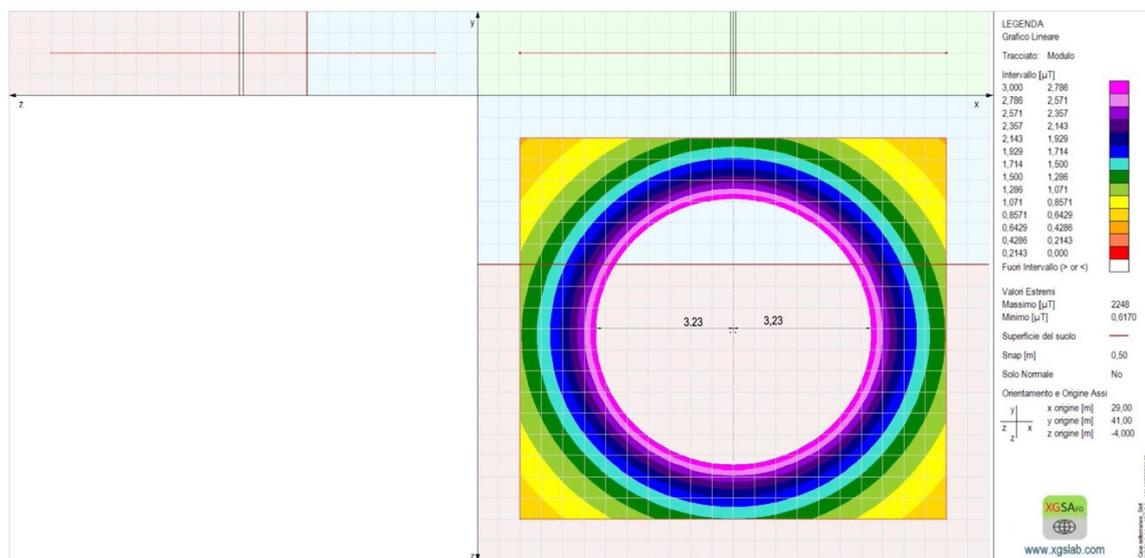
**Calcolo Induzione Magnetica sulla sezione del cavo AT da 1600 mm<sup>2</sup>**
