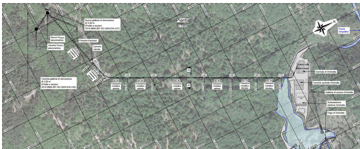
Figura 13: Condotta forzata e centrale di Orichella [49].
