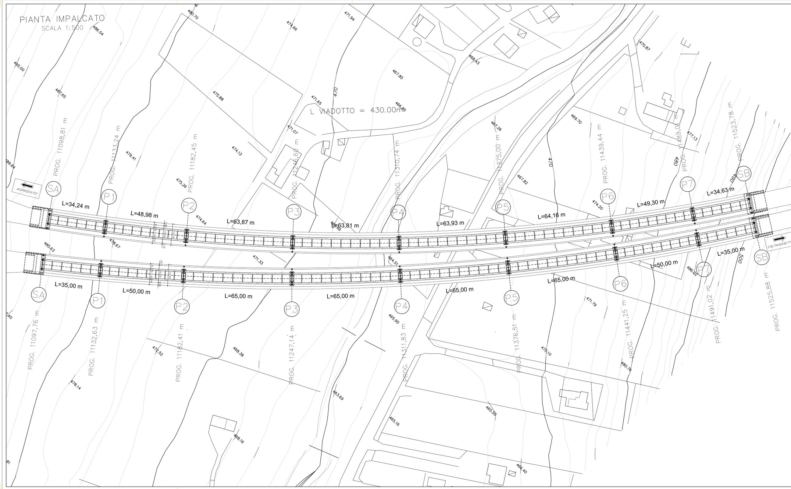
N.B. : GLI INTERASSI PILE SONO MISURATI SULL'ASSE IMPALCATO
