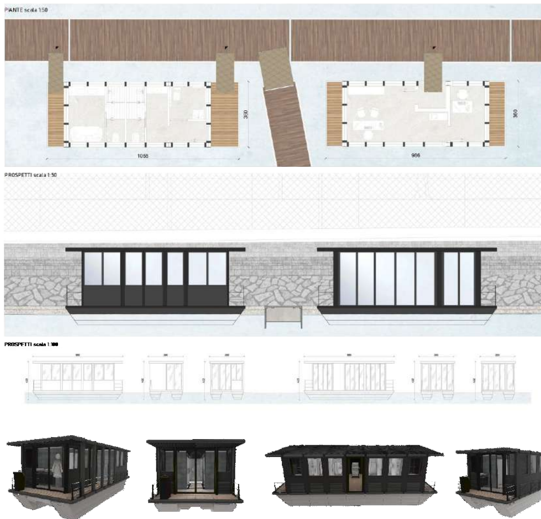
Figura 5.37 – Lago Maggiore – progetto del nuovo porto di Pallanza. Piante, prospetti e sezioni dei volumi di servizio e loro localizzazione rispetto al layout generale
