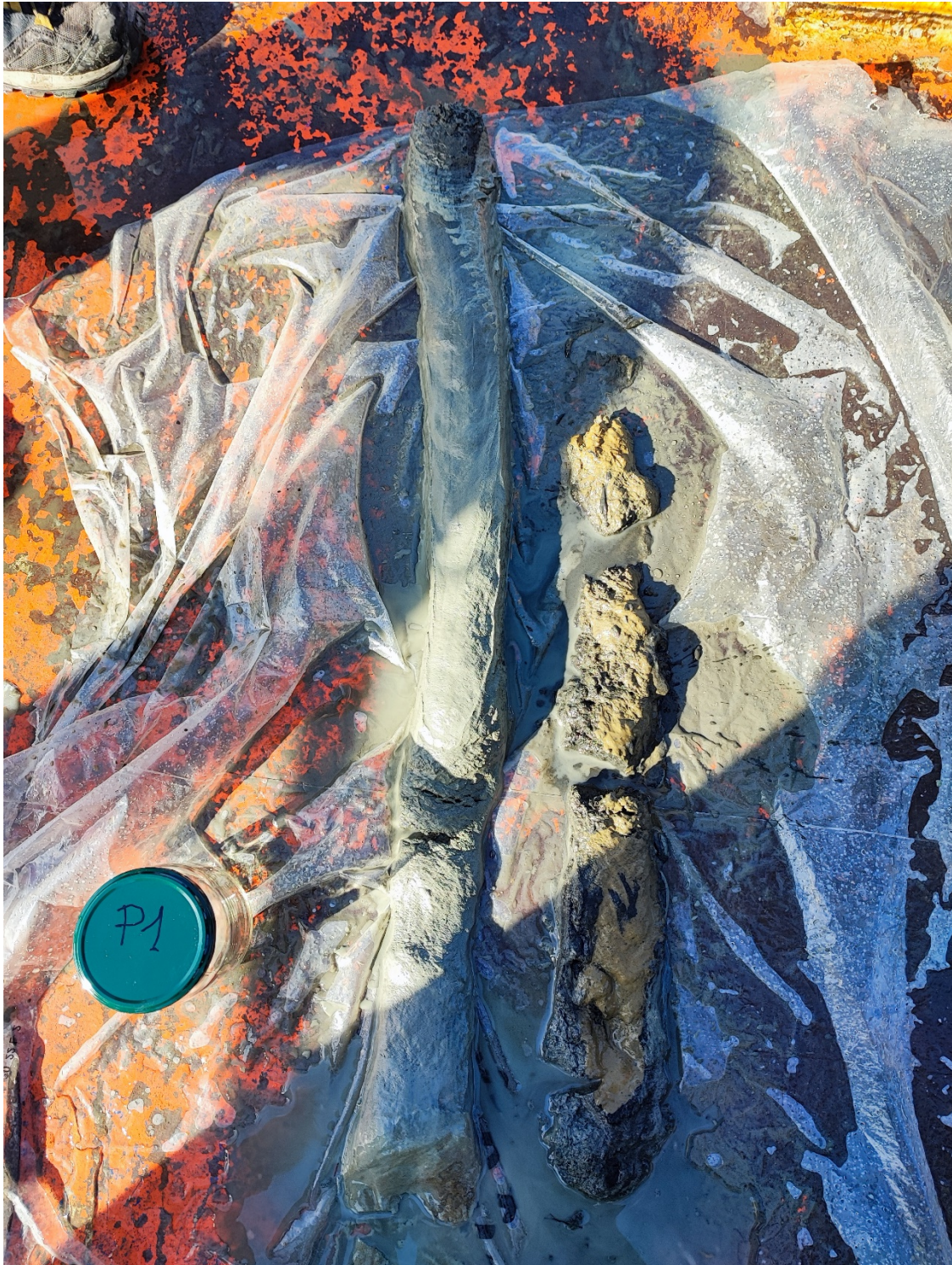
Figura 2: estrazione della carota campione P1
