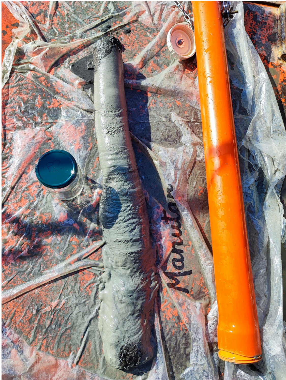
Figura 4: estrazione della carota campione P2
