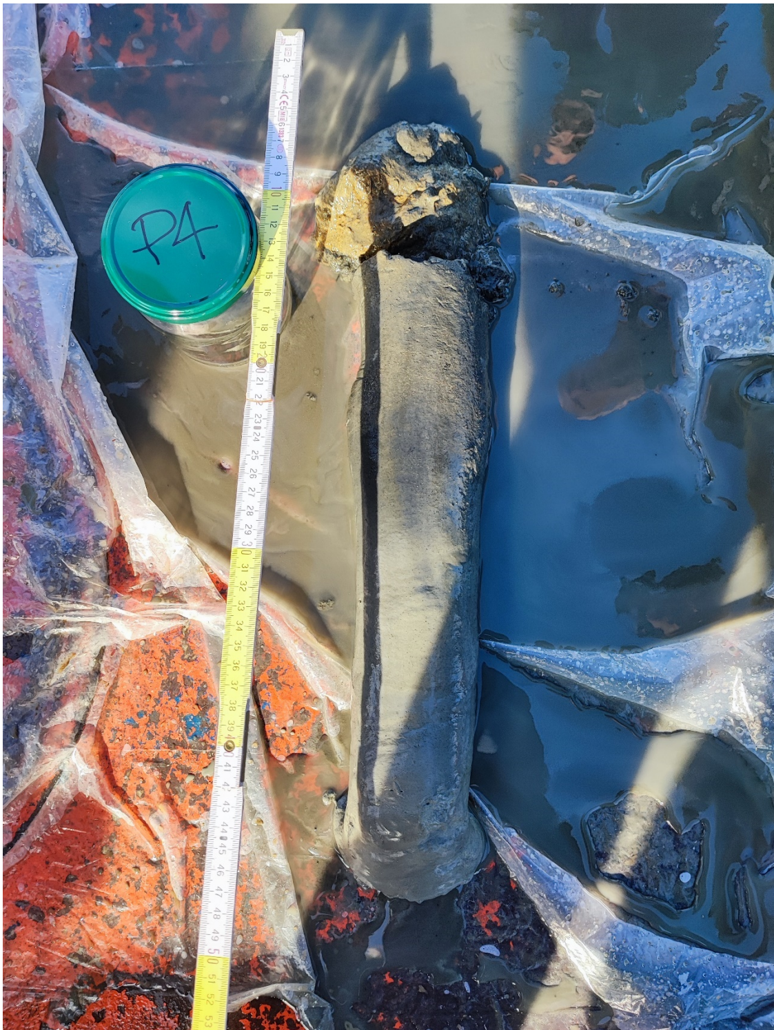
Figura 7: estrazione della carota campione P4
