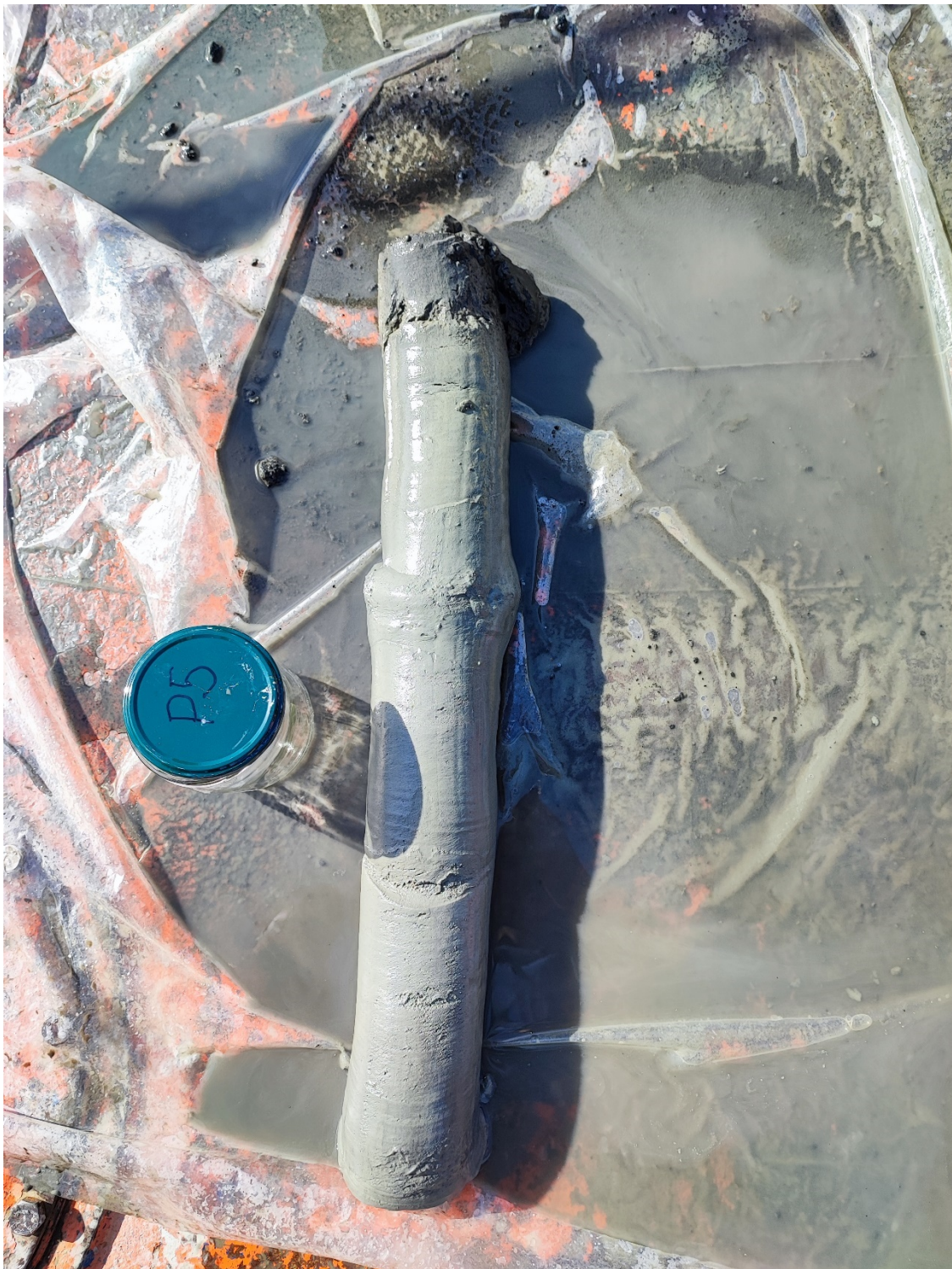
Figura 9: estrazione della carota campione P5
