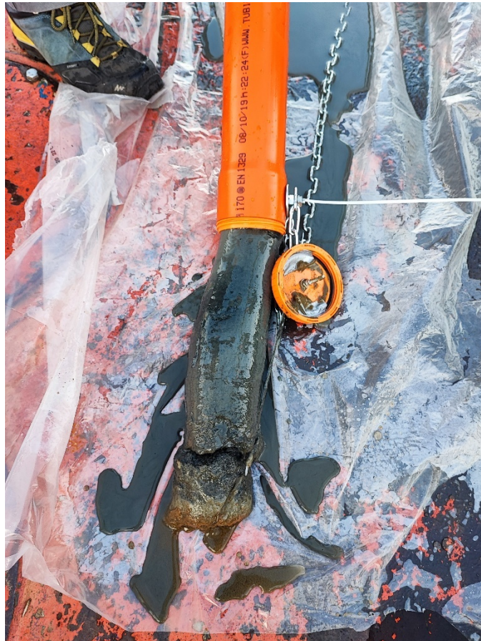
Figura 2: estrazione del campione dal carotiere
