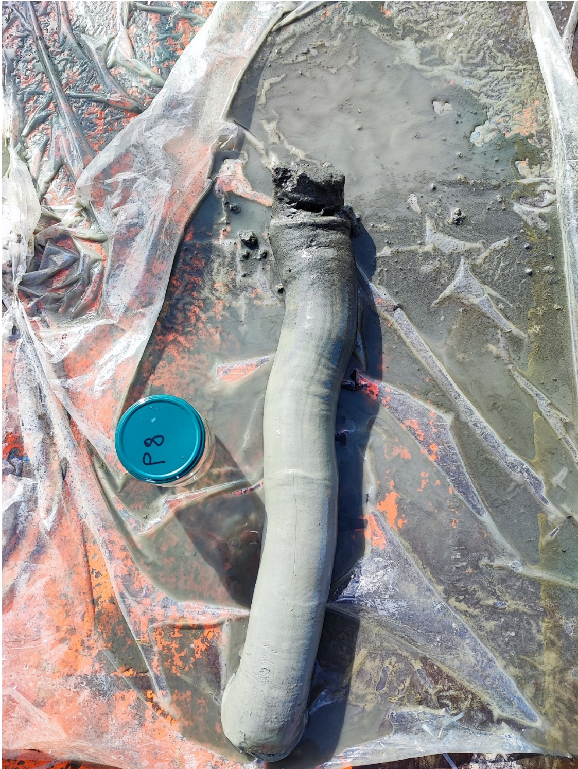
Figura 14: estrazione della carota campione P8
