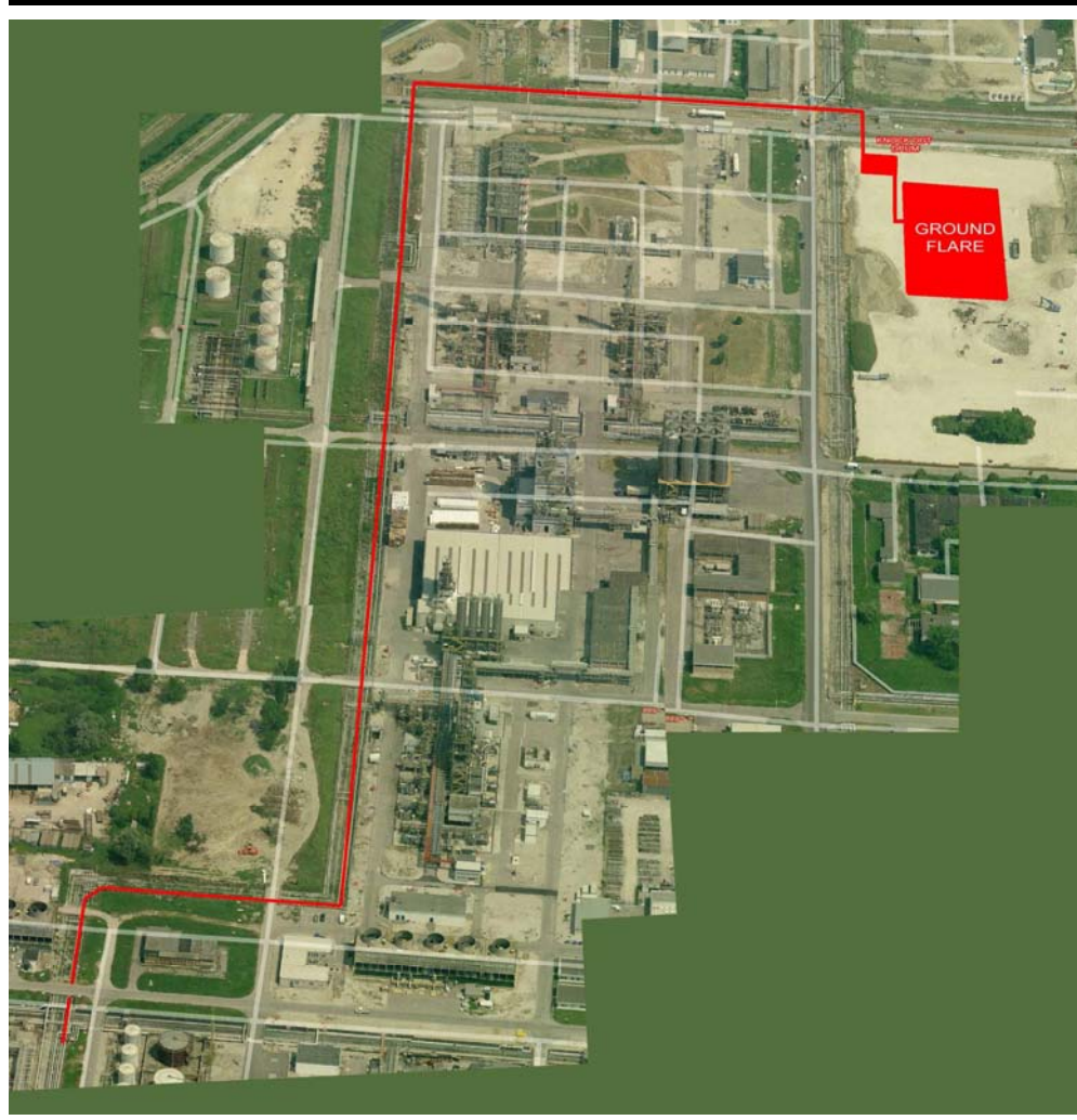
Figura 3.4 Lay-out nuovo collettore DN600
