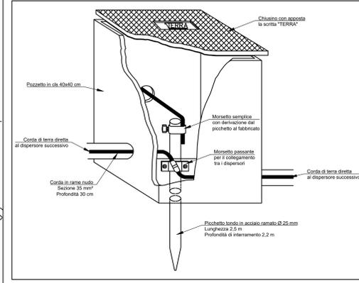
**PARTICOLARE COLLEGAMENTO CONDUTTORE DI TERRA E DISPENSORE DI FATTO** - Non in scala
