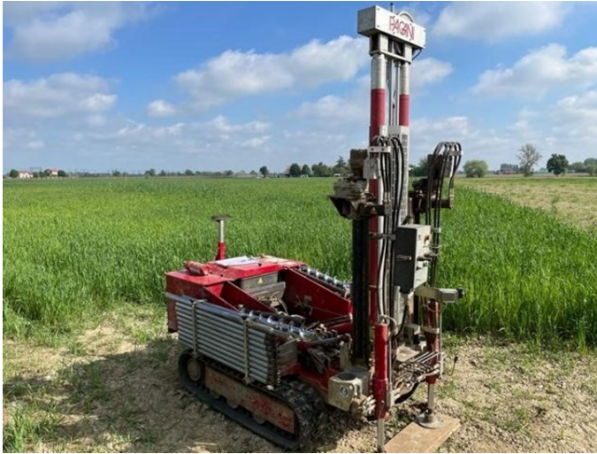
Figura 6-10 Strumento utilizzato per le indagini PAGANI TG 63.
