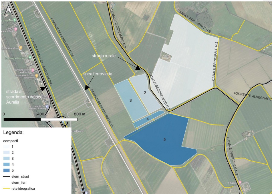
Figura 7-9: Corografia con indicazione dei comparti in cui si può dividere l'intero lotto seguendo il contesto rurale preesistente e l'individuazione della viabilità principale e della rete idrica che connota l'area.
