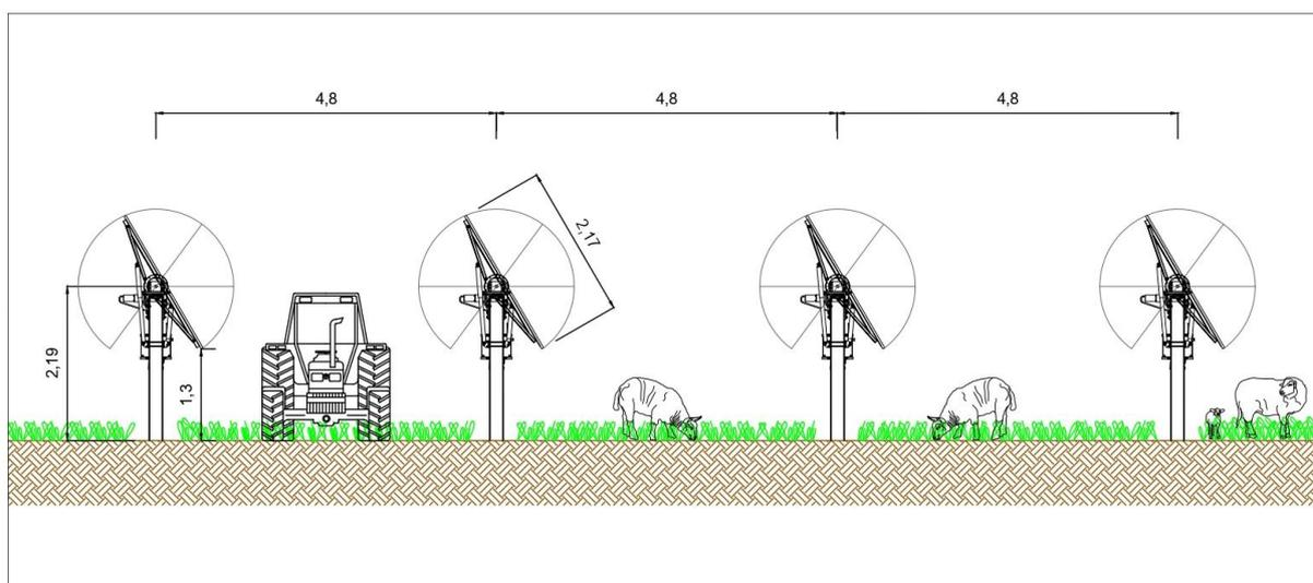
**Figura 3.** Caratteristiche del pannello
