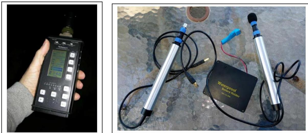
**Figura 20.** I bat detector utilizzati in questo studio: a sinistra il bat detector multifunzione D1000x Pettersson 1000; a destra i microfoni audio-ultrasonici Ultramic 384K di Dodotronic. Entrambi registrano i contatti ultrasonici full spectrum con una frequenza di 384 kHz e con file wav di durata di 5 secondi (su una scheda di memoria interna). L'autonomia degli Ultramic 384K – con power bank di 3 pile D- può arrivare a sette notti consecutive, con registrazione su 8-9 ore per notte.
