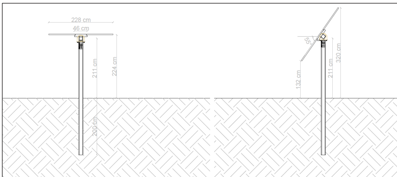
FIGURA 42 – TRACKER TIPO AD ASSE VARIABILE
