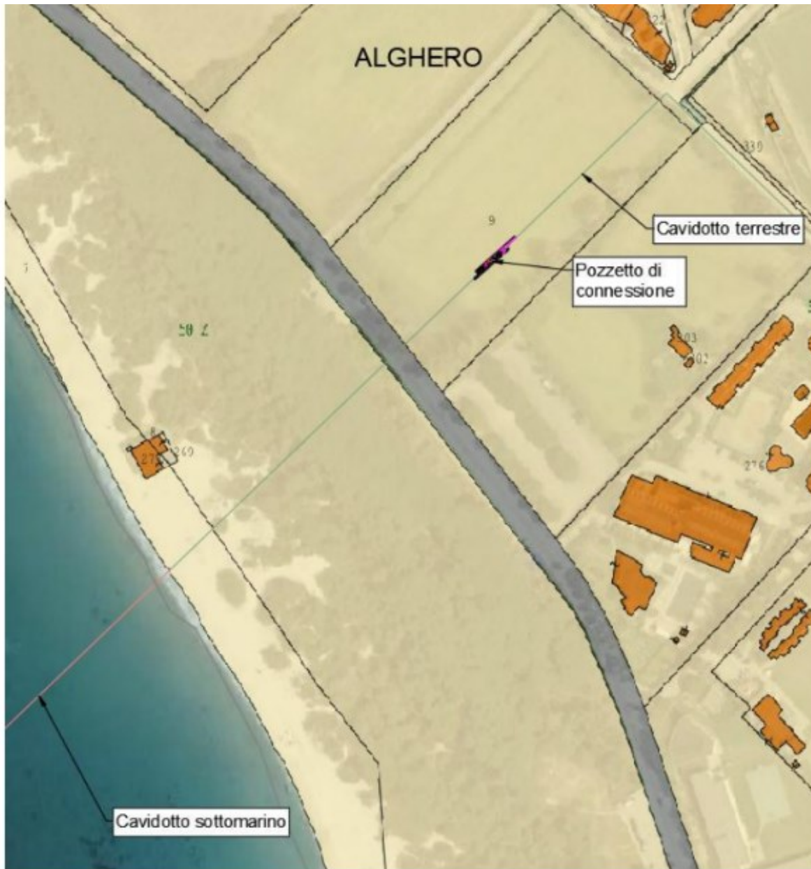
Figura 13: Sbarco a terra Cavidotto
