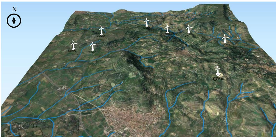
*Figura 3-7: inquadramento geomorfologico dell'areale in esame con indicazione del reticolo idrico, delle quote e dei rilievi*
